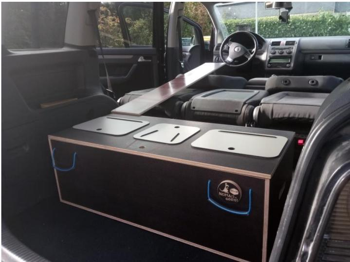
Ici le petit caisson de hauteur 30cm n'est pas adapté, on voit la planche qui se redresse vers l'avant du véhicule. Impossible de mettre un caisson de 30cm car le sommier ne serait pas plan.
