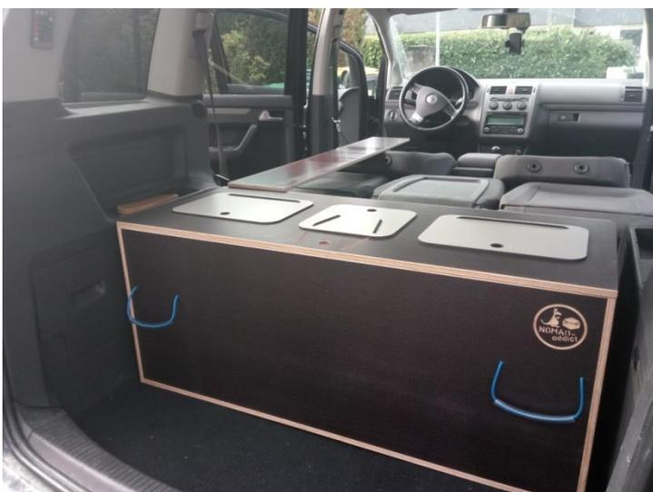
Par contre le caisson de hauteur 40cm est bien adapté. La planche est bien horizontale à une hauteur de 40cm.
